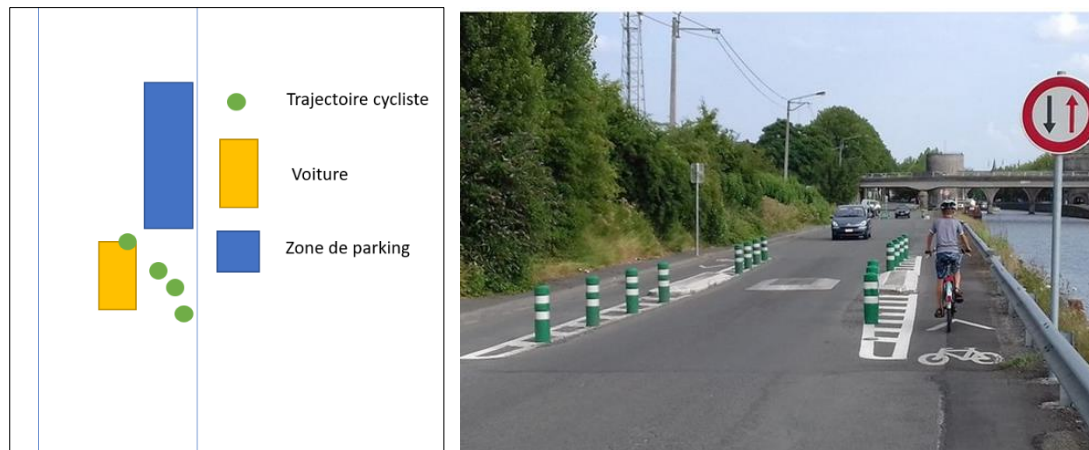
Figure 38 : Illustration du danger potentiel pour le cycliste de l'aménagement « chicane » (à gauche) et piste de solution (à droite).
